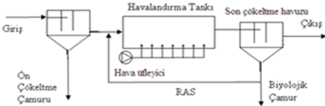
Şekil 5.1 : Atıksu Arıtma Tesisi İş Akım Şeması (Örnektir.)
